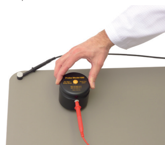
Anwendungsbeispiel: Messung mit Zylinderelektrode \varnothing 63,5 \text{ mm}
