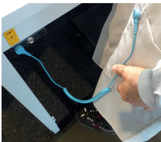
Erdung über Spiralkabel
