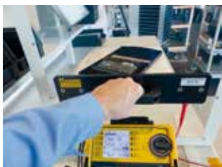
exemplu utilizare: masurare capac din acril
