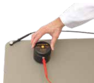
Exemplu utilizare: masurare cu electrodul cilindric
