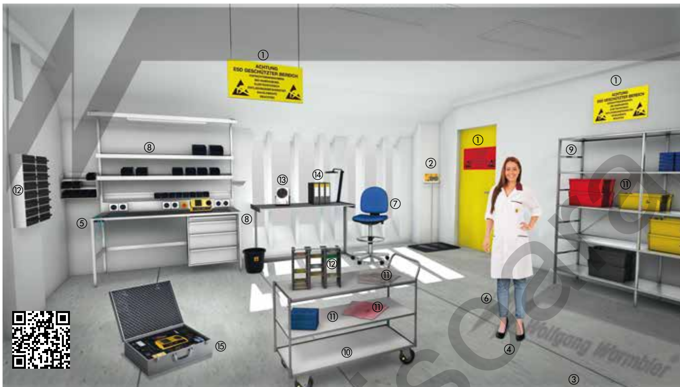
Zona protejată ESD (exemplu de configurație)
